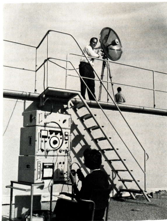
Bild 3 UHF-Feldstärkemeßanlage HFA mit Gleichspannungsschreiber Enograph-G und UHF-Meßparabol für 0,9 bis 2,7 GHz. Foto 9277
