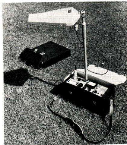
Bild 5 UHF-Feldstärkezeiger HUZ E mit logarithmisch-periodischer Antenne in geätzter Schaltung (470 bis 850 MHz). Foto 13413
