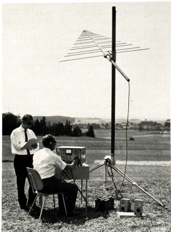
Bild 2 VHF-UHF-Feldstärkemeßgerät HFU mit logarithmisch-periodischer Breitbandantenne für Messungen bei 80 bis 900 MHz. Foto 11298
