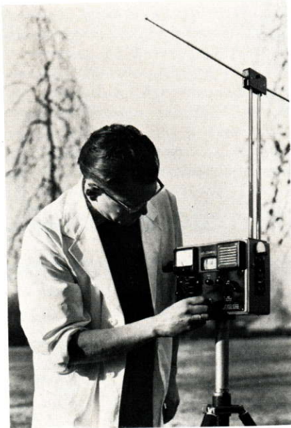
Bild 4 VHF-Feldstärkezeiger HUZ – ein besonders handliches Prüfgerät für den Frequenzbereich von 47 bis 225 MHz. Foto 6443
