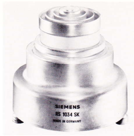
Bild 6 20-kW-UHF-Tetrode RS 1034SK mit Siedekondensations- kühlung
