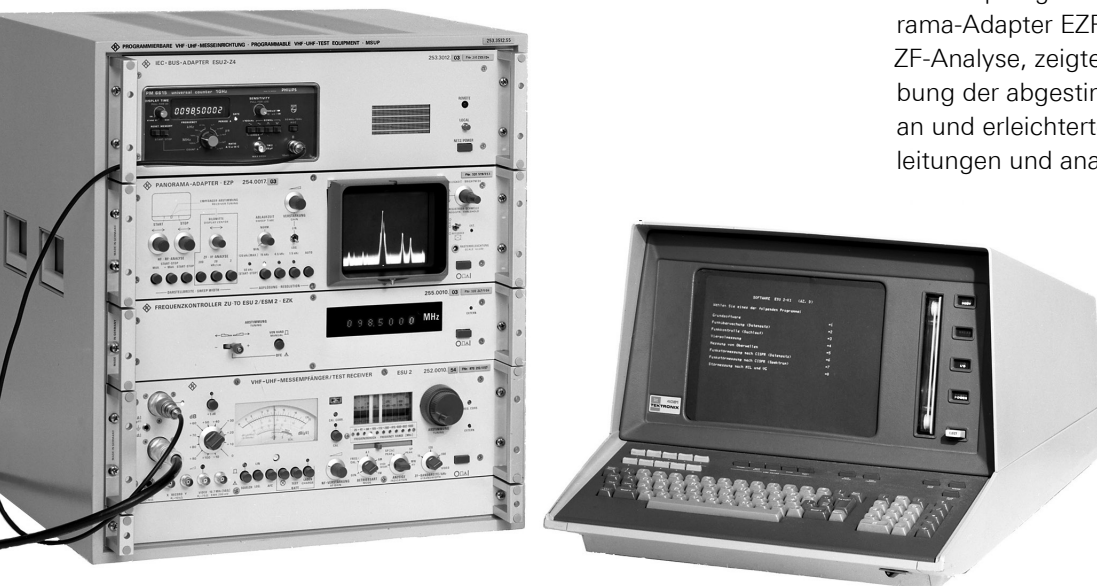
Bild 8: VHF-UHF-Messeinrichtung MSUP. Der gemeinsame Gerätekasten enthielt die Komponenten IEC-Bus-Adapter ESU 2-Z4 mit eingesetztem Frequenzzähler, Panorama-Adapter EZP, Frequenzkontrollierer EZK und Messempfänger ESU 2 (von oben nach unten). Der Tektronix-Tischrechner 4051 fasste alles zu einem automatisierten Messplatz zusammen.
