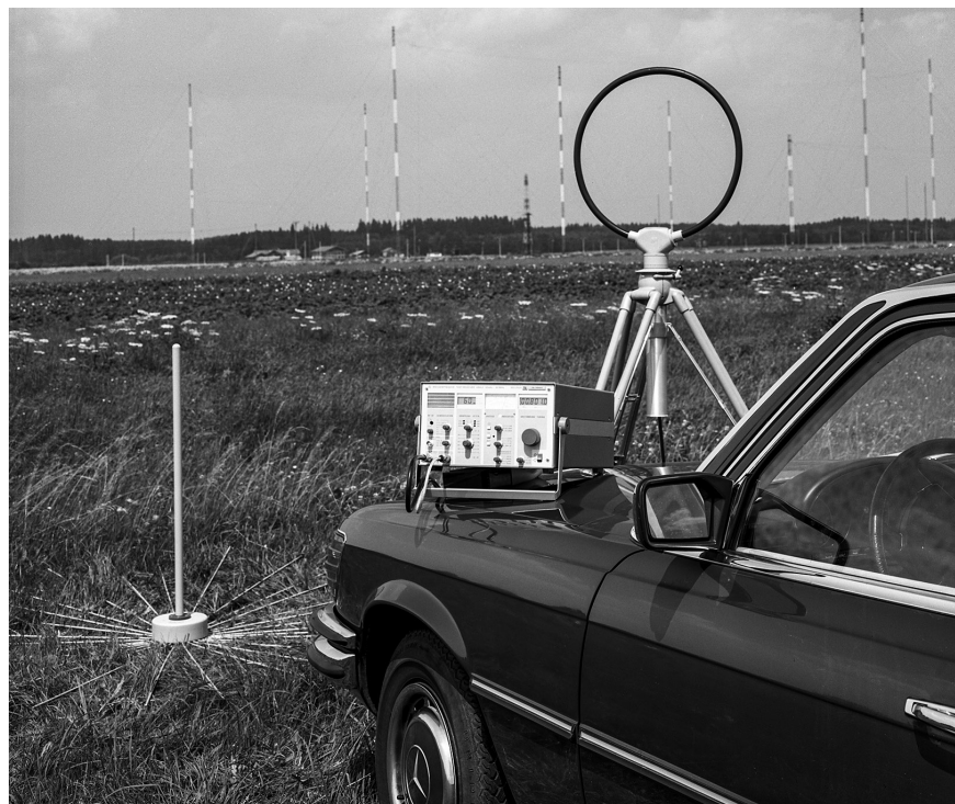
Bild 9: Feldstärkemessgerät HFH2 mit Messempfänger ESH2 und zugehörigen Antennen für den Frequenzbereich 9 kHz bis 30 MHz.
