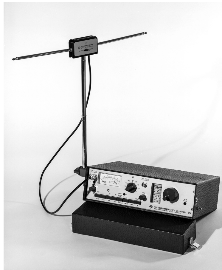
Bild 6: Mobiler VHF-Feldstärkemesser HFV mit Dipolantenne. Das Modell war nicht nur der erste volltransistorierte Rohde & Schwarz-Messempfänger, sondern auch der erste, der eine automatische Störbewertung gemäß VDE 0876 bzw. CISPR Publ. 2 durchführen konnte.
