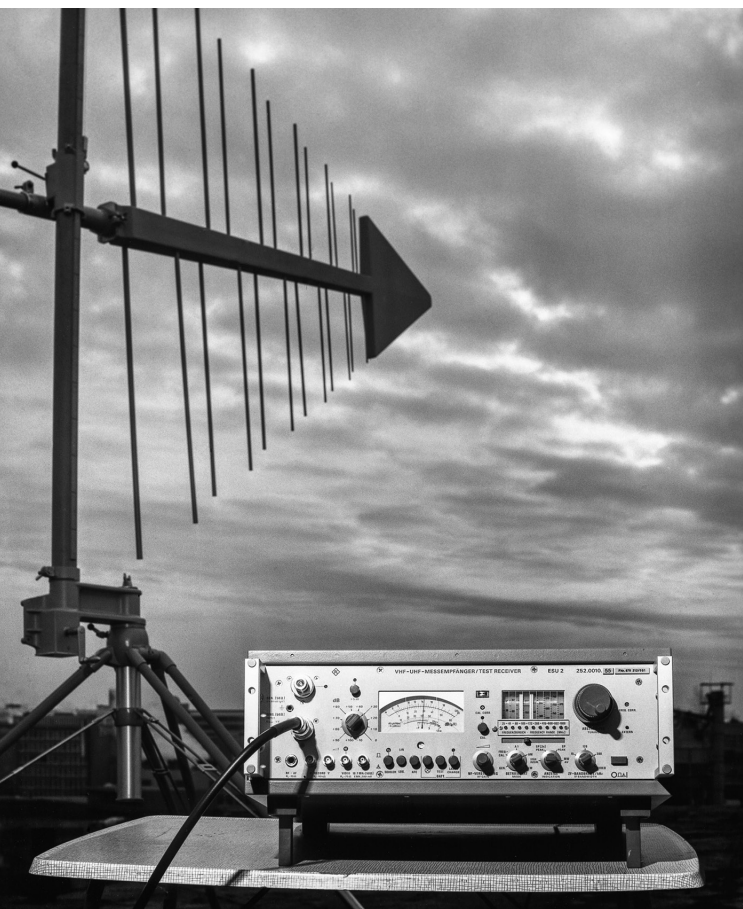
Bild 7: VHF-UHF-Feldstärkemessgerät HFU2 mit Messempfänger ESU2 und logarithmisch-periodischer Breitbandantenne HL 023 für 80 bis 1300 MHz.
