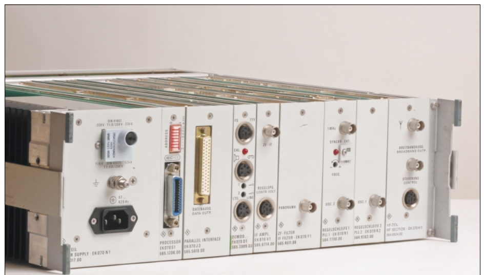
Die Rückseite zeigt den modulartigen Aufbau in Kassetten.
