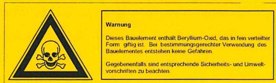
**In den Zeichnungen** (Schaltpläne, Bestückungspläne usw.) erfolgt die Kennzeichnung durch das nebenstehend abgebildete Gefahrensymbol mit Angabe der Gefahrstoffbezeichnung, z.B. BeO für Beryllium-Oxyd.
