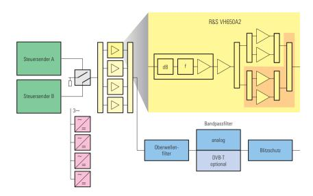
Dies minimiert die Verdrahtung im Sendergestell und erhöht die Betriebssicherheit. Die Verstärker erzeugen alle anderen für sie notwendigen Spannungen intern, womit wieder Redundanz gegeben ist. Das Netzteil ist dreiphasig als primär getakteter, kurzschlussfester Regler ausgeführt. Die Netzteile lassen sich während des Betriebs ohne Programmunterbrechung über Steckverbinder austauschen.
