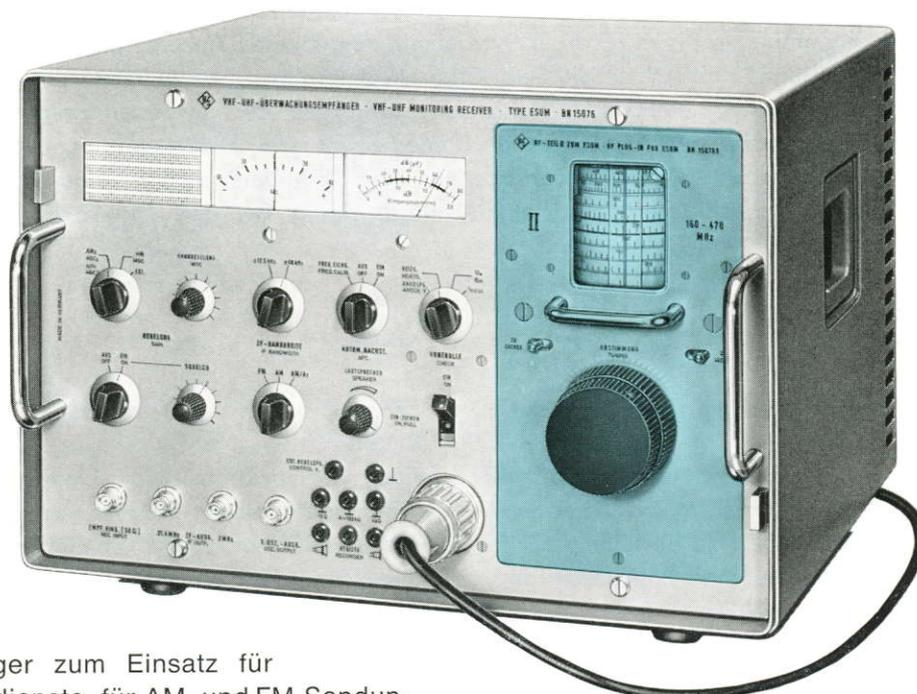
Funküberwachungsempfänger zum Einsatz für feste und bewegliche Funkdienste, für AM- und FM-Sendungen, Flugfunk und alle anderen Funksignale im VHF-UHF-Bereich
