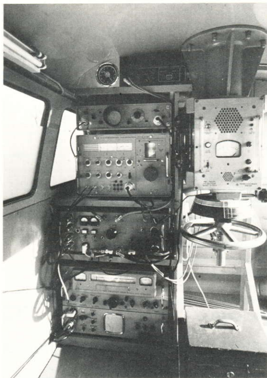
Bild 2 Innenausstattung des Funkmeßwagens mit VHF-Peiler, VHF-UHF-Überwachungsempfänger ESUM mit Panoramazusatz ESUP und Flugsicherungsempfänger von Rohde & Schwarz sowie Service-Frequenzmesser FD 100 von Schomandl.
