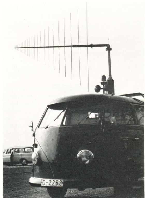
Bild 1 Funkmeßwagen der Berufsfeuerwehr Düsseldorf mit logarithmisch-periodischer Antenne von Rohde & Schwarz.
