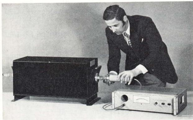
Leistungsmessung mit dem Dämpfungsglied RBU und dem Thermischen Leistungsmesser NRS. Der Meßkopf des NRS wird mit dem Dämpfungsausgang des RBU verbunden.
