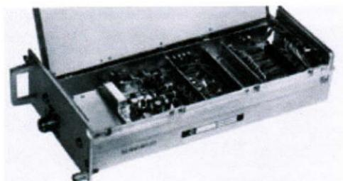
**Bild 3: Einzelner Baustein, hier ein Hochfrequenzteil.**
