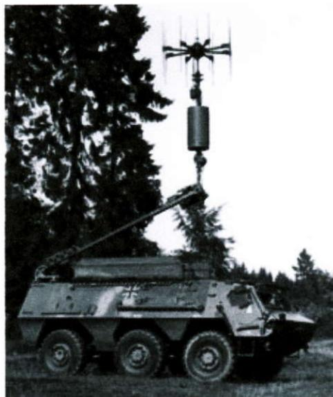
**Bild 8:** HF/VHF-Peilpanzer (1-200 MHz). Der Antennenmast wurde hydraulisch aufgeklappt und aufgerichtet, dabei entfaltete sich die H-Adcock-Peilantenne 20-200 MHz (für 1-20 MHz musste eine mitgeführte U-Adcock-Peilantenne abgesetzt vom Transportpanzer auf dem Erdboden aufgebaut werden). Der tonnenförmige Behälter am Mast unterhalb der Peilantenne enthielt Schlitzantennen unterschiedlicher Richtung für die UHF-Datenverbindung zur Auswertung.
