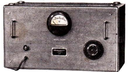
Aussenansicht des Netzspannungskonstanthalters für 1 kVA-Durchgangsleistung.
