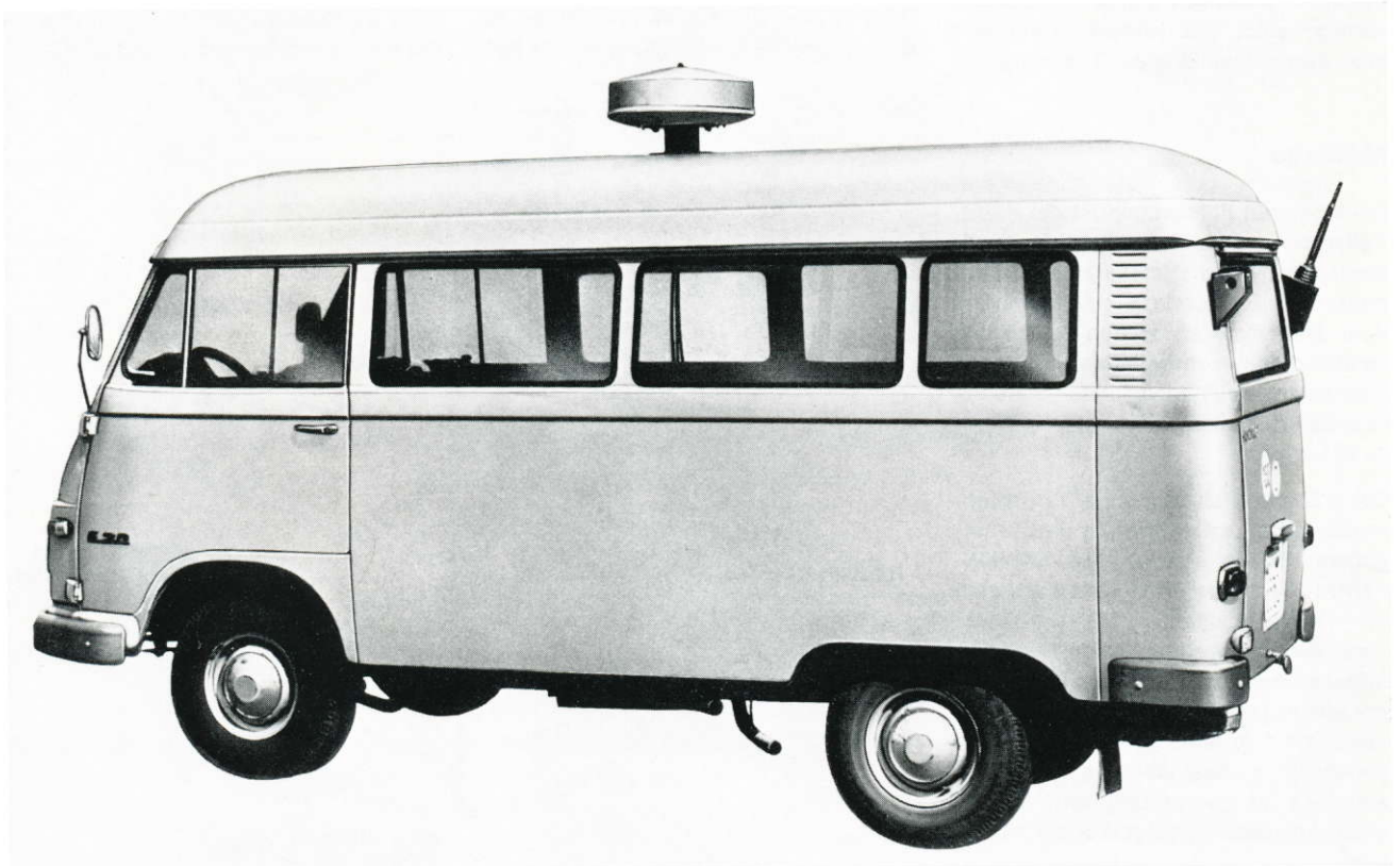
VHF-Ferrit-Peilantenne PR 1195, ungetarnt auf Kraftfahrzeug montiert
