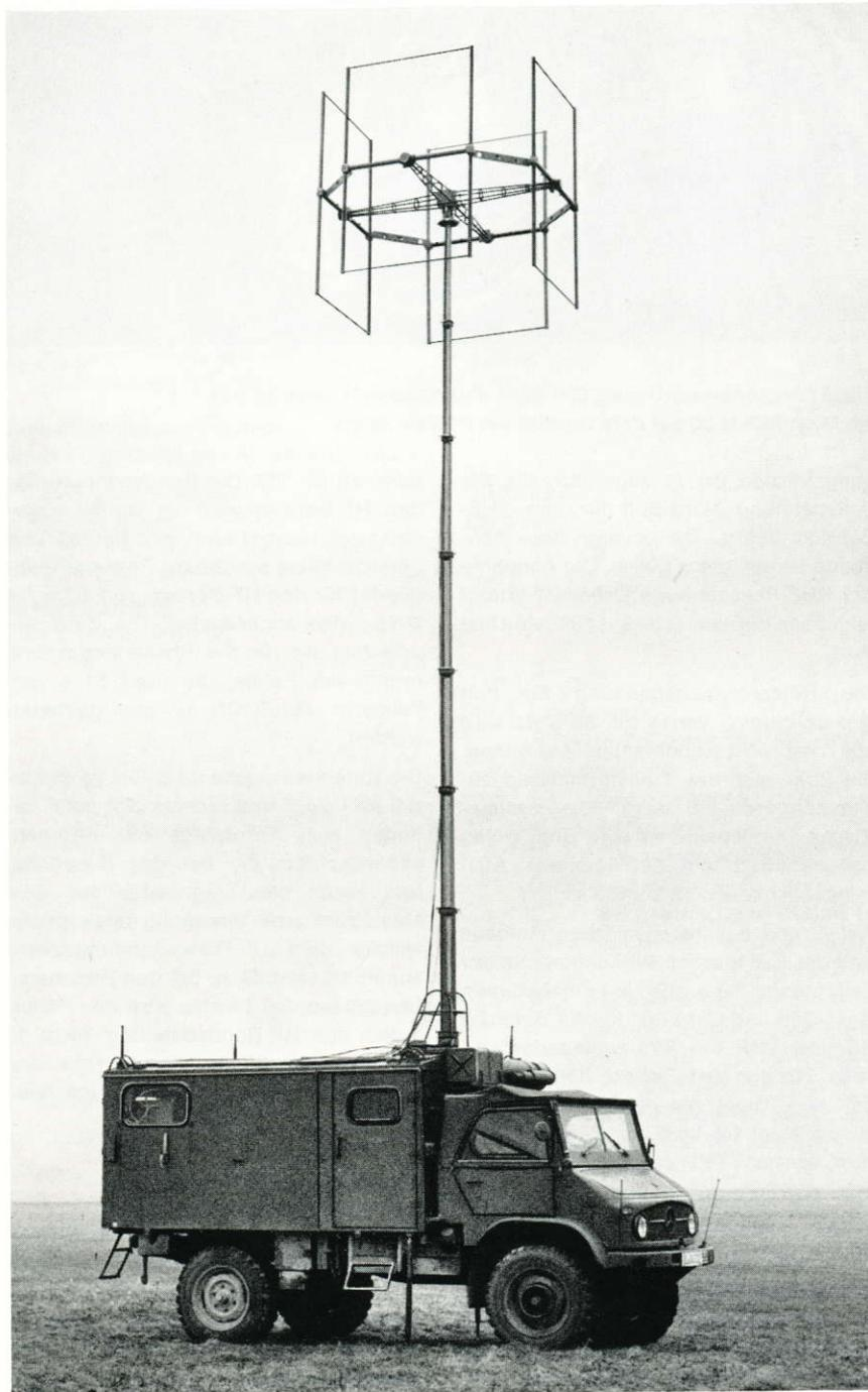
HF/VHF-Peilantenne A 638-BWH auf Peilfahrzeug mit pneumatisch
