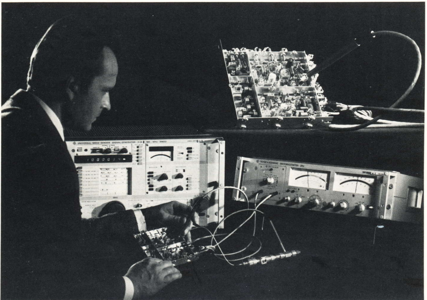
BILD 1 Verstärkermessung mit Vektorvoltmeter ZPU und Universal-Meßsender SMDU. Die winzigen Tastspitzen des ZPU ermöglichen Messungen an praktisch jedem Punkt der Baugruppe. Foto 23 390
