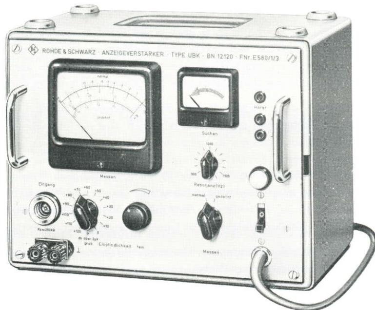
Ein hochempfindlicher selektiver Universal-Nullspannungsverstärker mit zusätzlicher Spannungsverlaufsanzeige (Sucheinrichtung) bei übersteuertem Hauptinstrument
