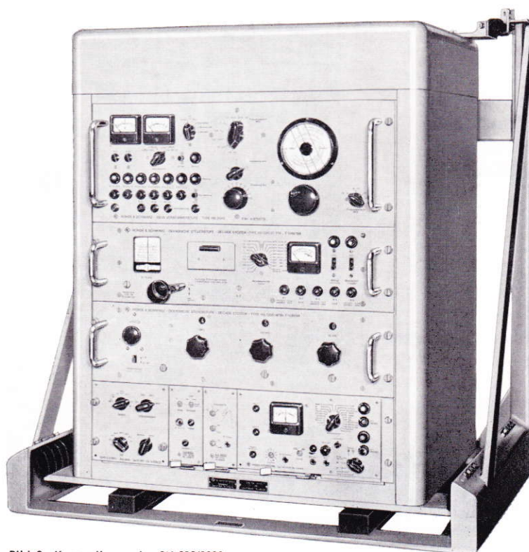
Bild 2 Kurzwellensender SK 010/3202, in Schwingrahmen montiert
