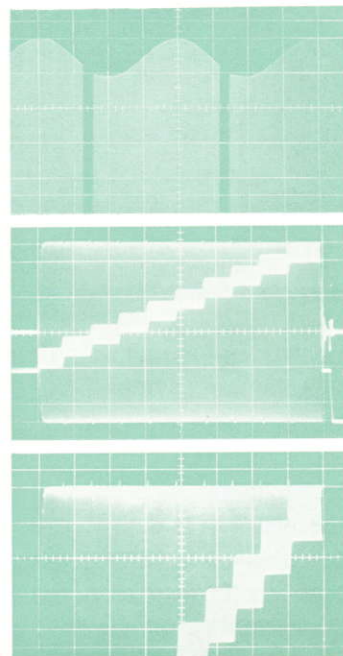
Oben: Messung einer 50-Hz-Störüberlagerung bei Bild weiß (zehnfach übersteuert) Mitte: Linearitätsmessung im Intermodulations-Meßverfahren Unten: wie Mitte, jedoch dreifach übersteuert (Meßgenauigkeit < 0,25\% ) Mitte und unten doppelt belichtet
