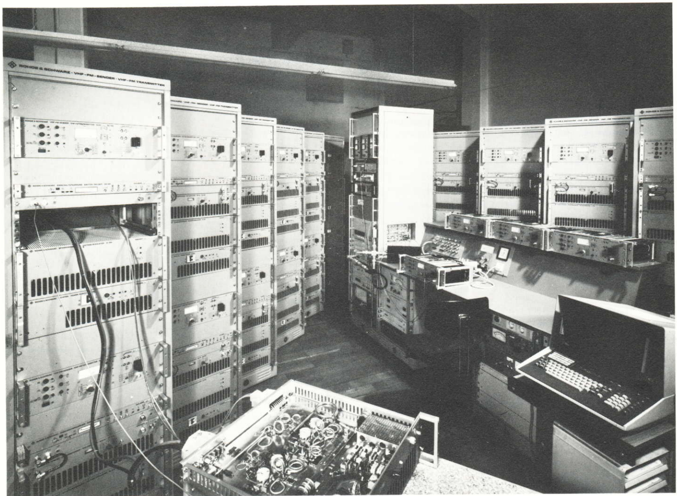
BILD 1 Endprüfung der volltransistorisierten VHF-FM-Sender im R&S-Fertigungswerk Memmingen.
