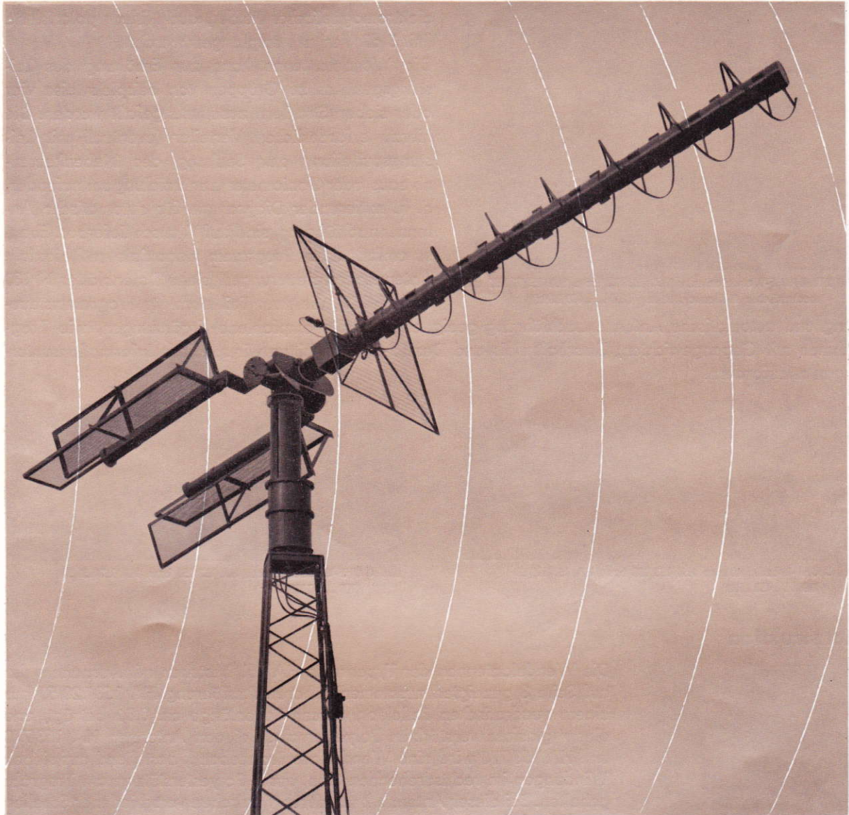
Bild 1 VHF-Wendelantenne HA 153/740 als Empfangsantenne für Wettersatellitensignale (Frequenzbereich 100 . . . 200 MHz)
